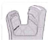
SI LES CAPTEURS SONT SALES, L'APPAREIL VA FONCTIONNER SEUL SANS UTILISATEUR ET SE METTRE AUTOMATIQUEMENT HORS SERVICE POUR EVITER UNE SURCONSOMMATION ELECTRIQUE
