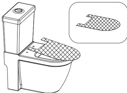
Placer le gabarit sur votre cuvette en laissant apparaître les trous de la cuvette.
