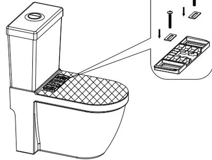
En vous référant au schéma, installer la platine de fixation, les plaques en métal, et les vis dans l'ouverture du gabarit
