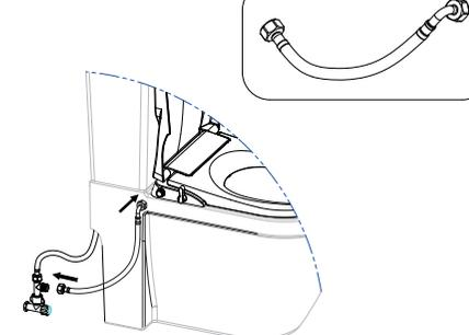
Installer le flexible fourni en connectant la partie coudée sur l'abattant et la partie droite sur la vanne 3 voies fournie.
