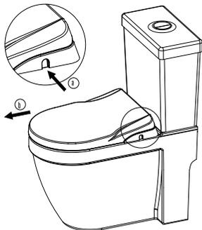
Couvercle fermé. Appuyer sur le bouton de déclipage latéral en faisant glisser l'abattant vers l'avant.
