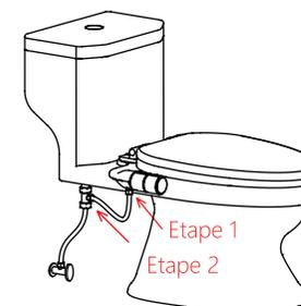
5. Visser le flexible sur l'entrée d'eau de la douchette japonaise puis visser le flexible au Raccord en T. Visser le Raccord en T sur votre arrivée d'eau.
