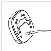
A la première utilisation, brancher le câble USB sur le stérilisateur pour le charger. **La lumière face avant clignote une fois.** Cela indique que c'est activé. **Charger 1h et débrancher.**
