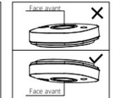
Le mode de stérilisation fonctionne seulement en situation ✓. C'est à dire lorsque le couvercle est fermé, la face avant du stérilisateur est en direction du trou de votre cuvette et que le stérilisateur est correctement installé sur son support.
