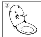
Coller le support sur le couvercle en respectant le sens (flèche vers le haut). Appuyer sur le support pour bien le fixer.
