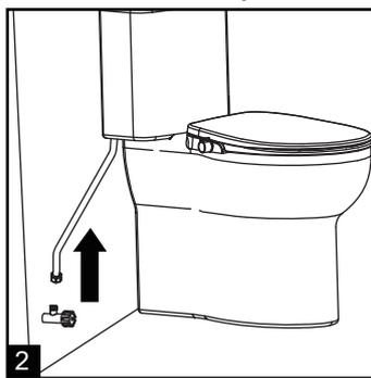
Installer notre vanne, connecter notre flexible à la vanne et à l'abattant, rebrancher votre tuyau à la nouvelle vanne. Ouvrir doucement l'eau.
