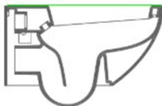
**Si la cuvette présente un bouelet à l'arrière, celui-ci ne doit pas être mesuré**
