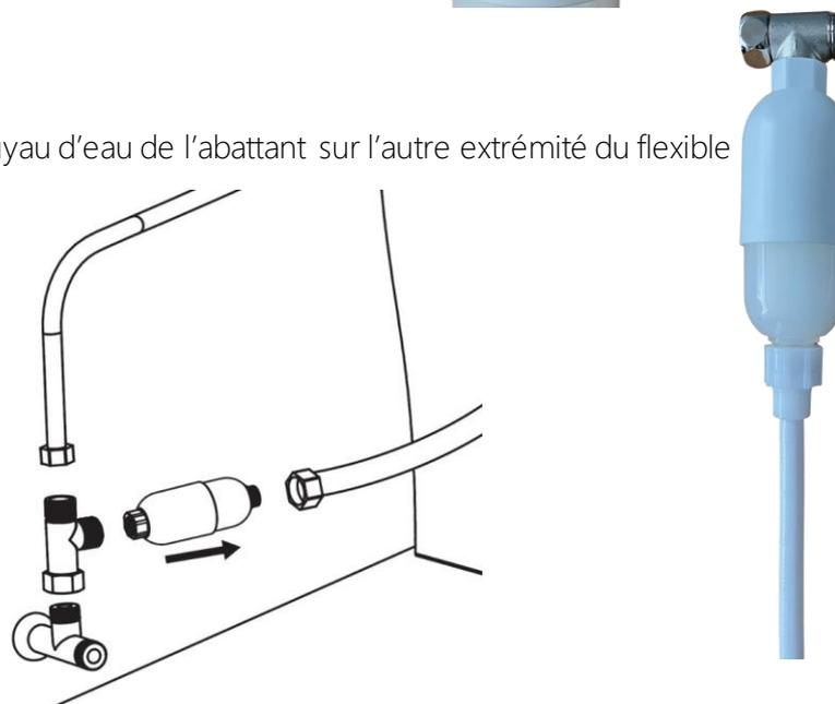
**Étape 3 :** Ouvrez doucement le robinet d'eau et vérifiez que l'étanchéité est bien faite.
